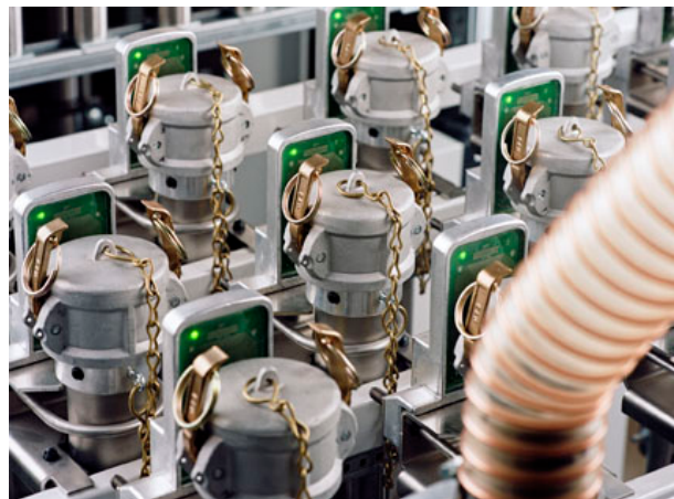
CODEMAX RFID coupling station from WITTMANN. 威猛（WITTMANN）的 CODEMAX RFID 選料站。
