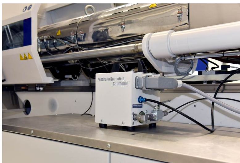
Fig. 3a: CELLMOULD® module on a MacroPower 1100
