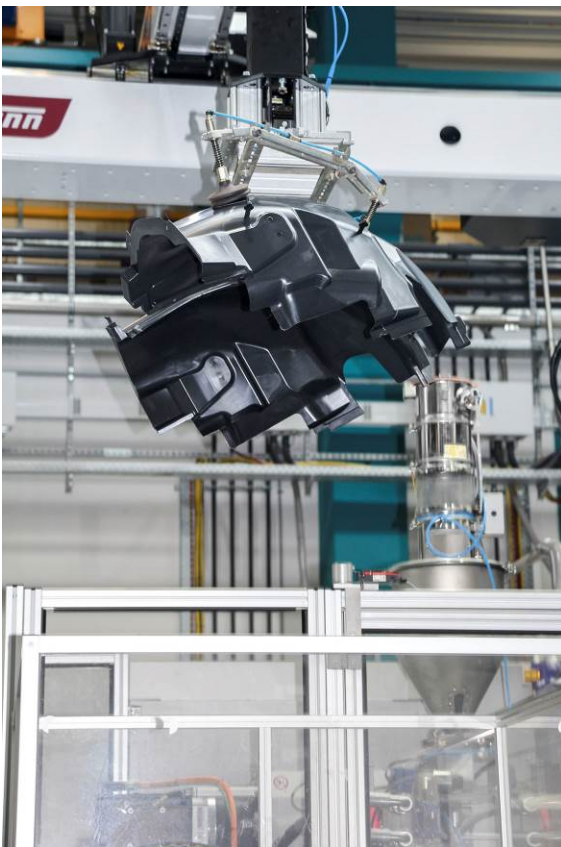
Fig. 4: Removal and depositing of a wheel arch liner by a WX173 robot from WITTMANN (Photo: WITTMANN BATTENFELD) 圖 4：WITTMANN 的 WX173 機器手取出汽車部品（照片：WITTMANN BATTENFELD）
