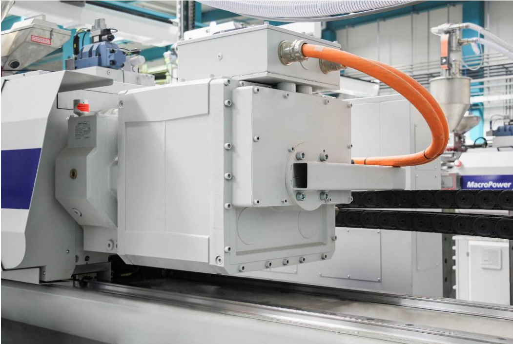
Fig. 3: Servo-electric screw drive on a MacroPower 2000 (Photo: WITTMANN BATTENFELD) 圖 3：MacroPower 2000 上的伺服電動驅動螺桿（照片：WITTMANN BATTENFELD）
