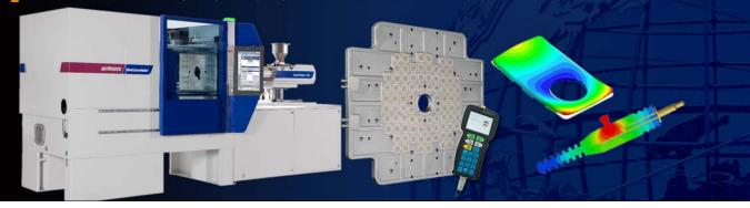
雙色射出成型是一種高效率的製作過程,它使用異材塑料可相互聚合的特性,同時搭配多種顏色、原料或複雜設計的元件在射出成型機中射出成型完成。與其他製作方式相比,雙色射出成型可實現多功能性、更簡單的生產和成本效益更好。但因同時架上兩付模具,因空間受限大幅增加換模鎖模的困難度,往往一次傳統換模需要停機 40 分鐘以上,使用磁力鎖模系統實際換模鎖模時間僅需 3 分鐘,大幅縮短換模時間,提昇射出成型的稼動率。
